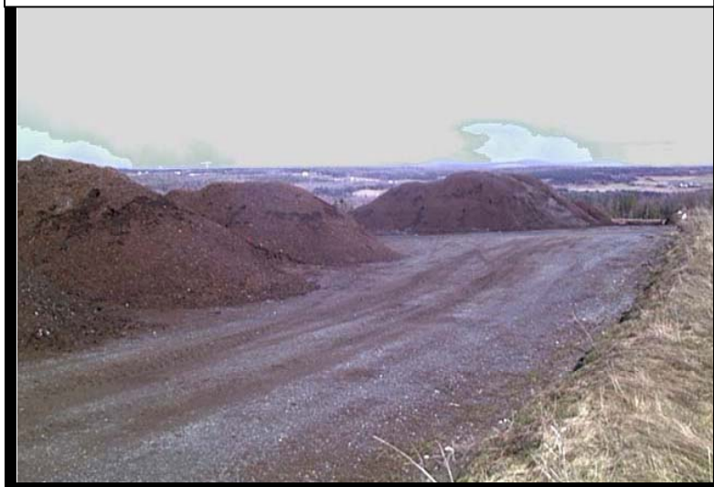
Andains sous forme de Piles Statiques
