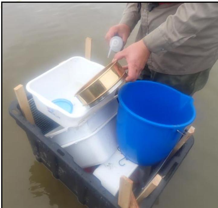
*Figure 4. Dispositif de tamisage*
