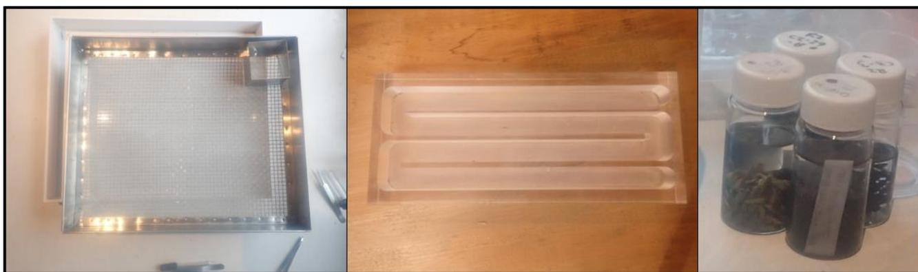
*Figure 5. Fractionneur de Caton (gauche), plateau de tri Bogorov (centre) et fioles de spécimens (droite)*
