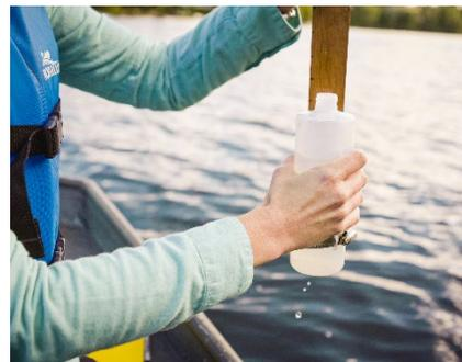
L'échantillonnage de la qualité de l'eau est effectué en utilisant une bouteille, fixée sur un porte-bouteille, que l'on descend graduellement jusqu'à 1 mètre sous la surface de l'eau. Quant à la transparence, celle-ci est mesurée à l'aide d'un disque de Secchi. La transparence de l'eau correspond à la profondeur à laquelle le disque n'est plus visible à partir de la surface (MELCC et CRE Laurentides 2016 et 2017).
